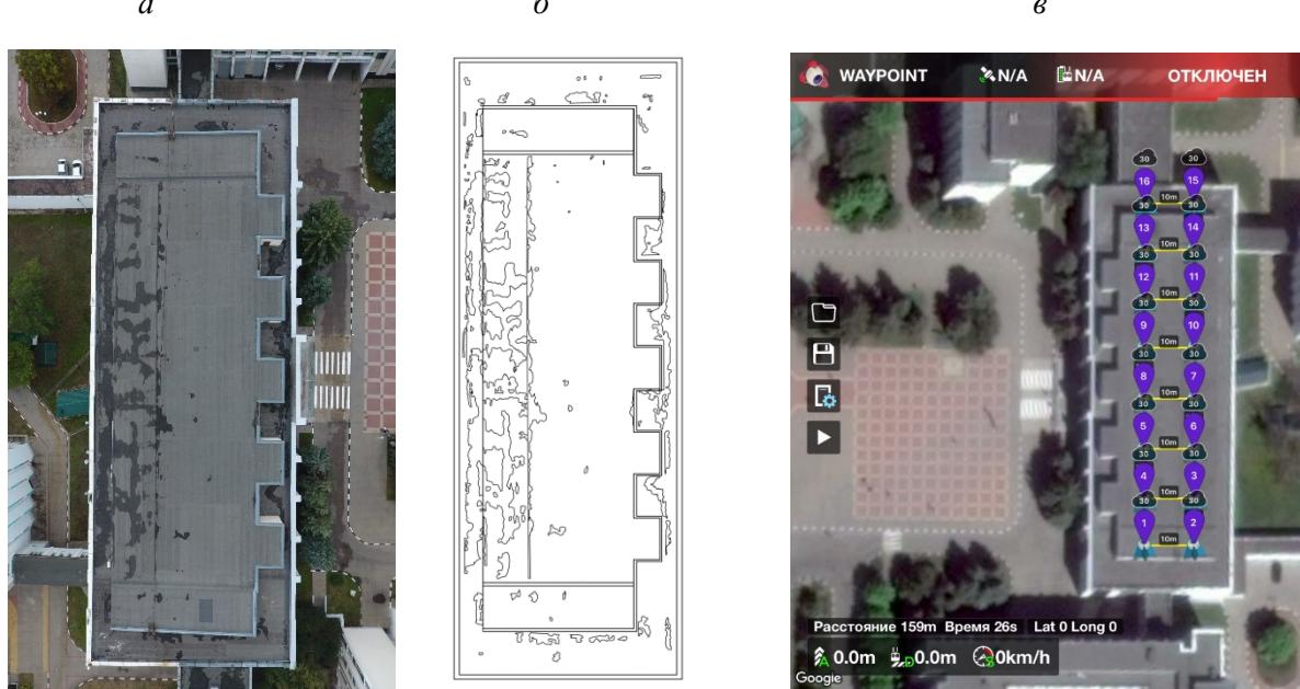
Рис. 7. Практическая работа в инженерном приложении при автоматизированном распознавании дефектов плоской рулонной кровли общественного здания в г. Белгороде:
